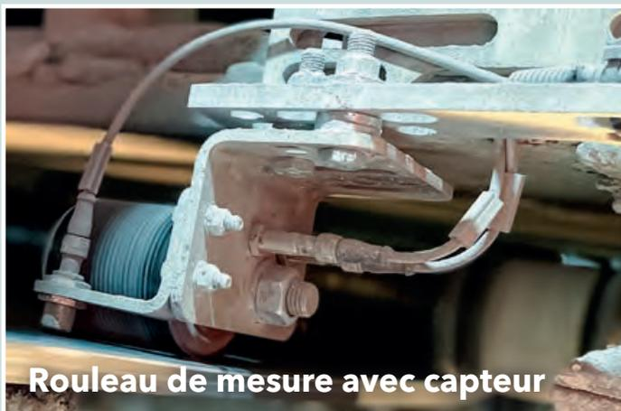
**Rouleau de mesure avec capteur**
